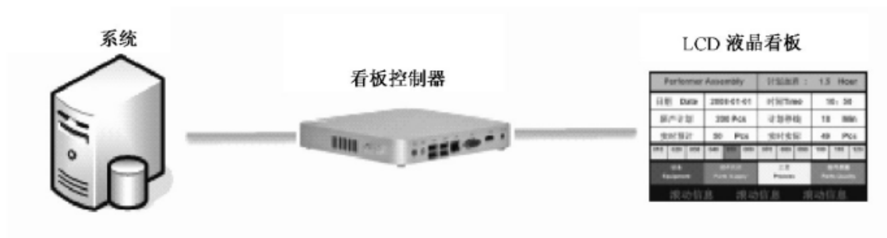
图 A.2 典型的 LCD 看板系统架构
