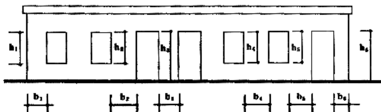
图 3.2.1 墙段高宽示意
