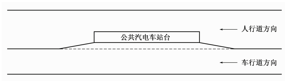
图2 沿人行道和非机动车道设置的港湾式站台
