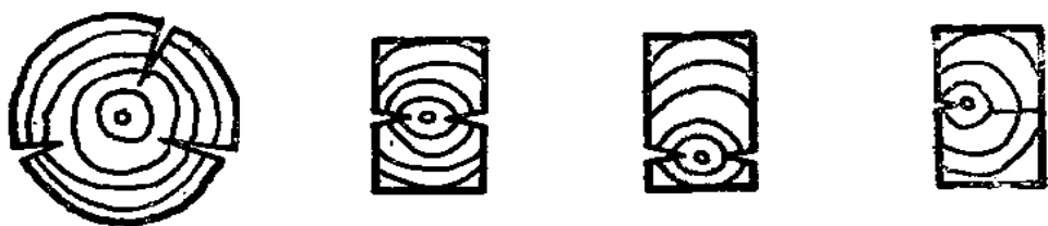
图2.1.5-2 木材干缩裂缝位置与髓心的关系
