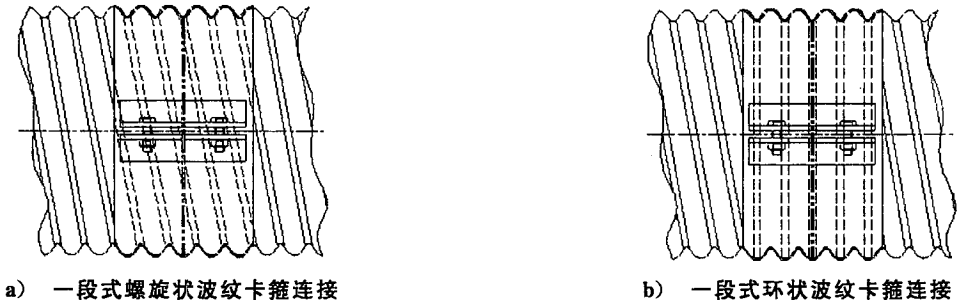
图 A.3 一段式螺旋状波纹卡箍、环状波纹卡箍连接示意图
