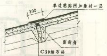
3 板间分格缝构造
