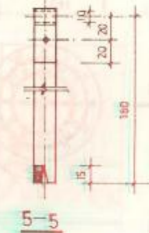
屋面避雷网支架和支座
