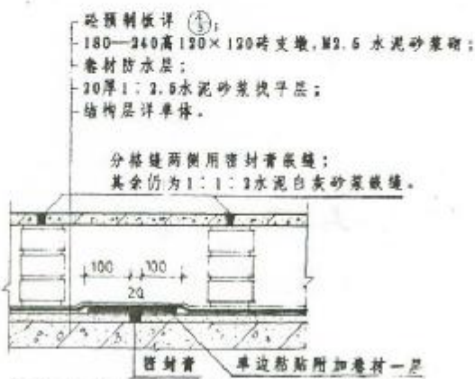
3 架空隔热层屋面分格缝构造
