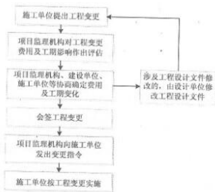
图 10.2.2 项目监理机构处理工程变更程序
