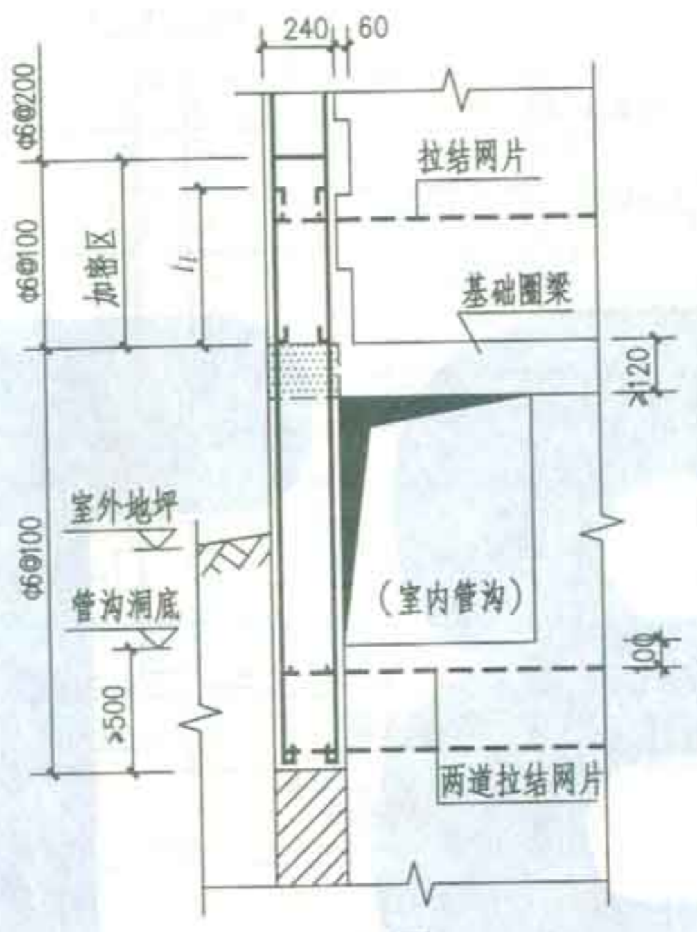
③ 靠墙管沟处
