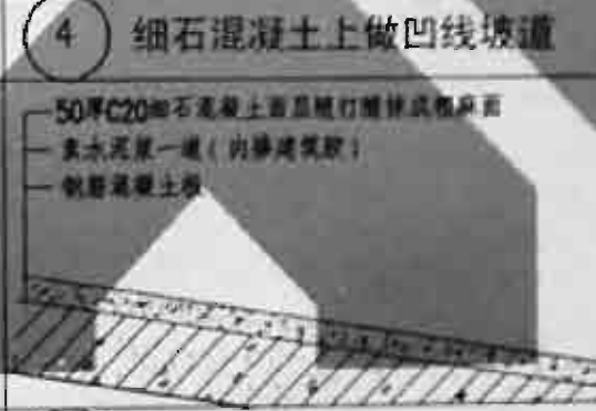
8 麻面细石混凝土坡道
