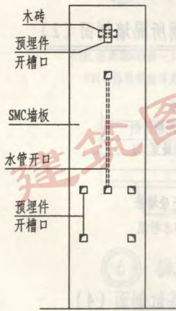
墙内预埋件开槽示意图
