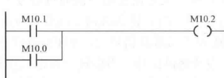
Network6: 若在起始位置, 则旋转至工件托盘处
