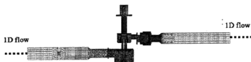
图 10.37 减压器入口出口边界处理
