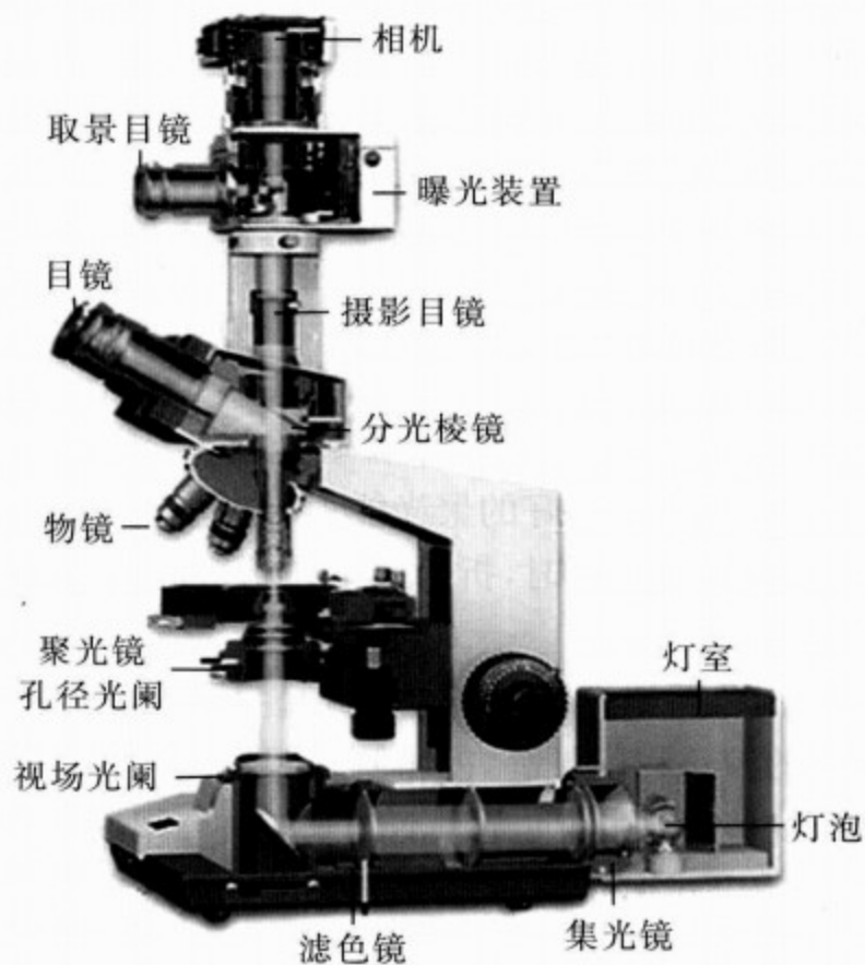
图 8-8 显微镜光学系统组成
