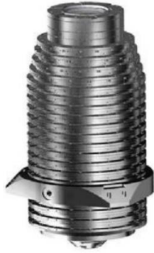
图表32：光刻机投影物镜重量可达 500kg
