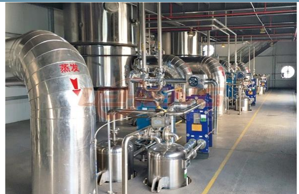
图表23: 7T/h乙醇提取小叶榕溶液MVR蒸发浓缩系统项目
