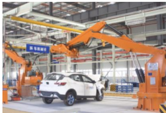
图表 天奇股份报废汽车拆解生产线
