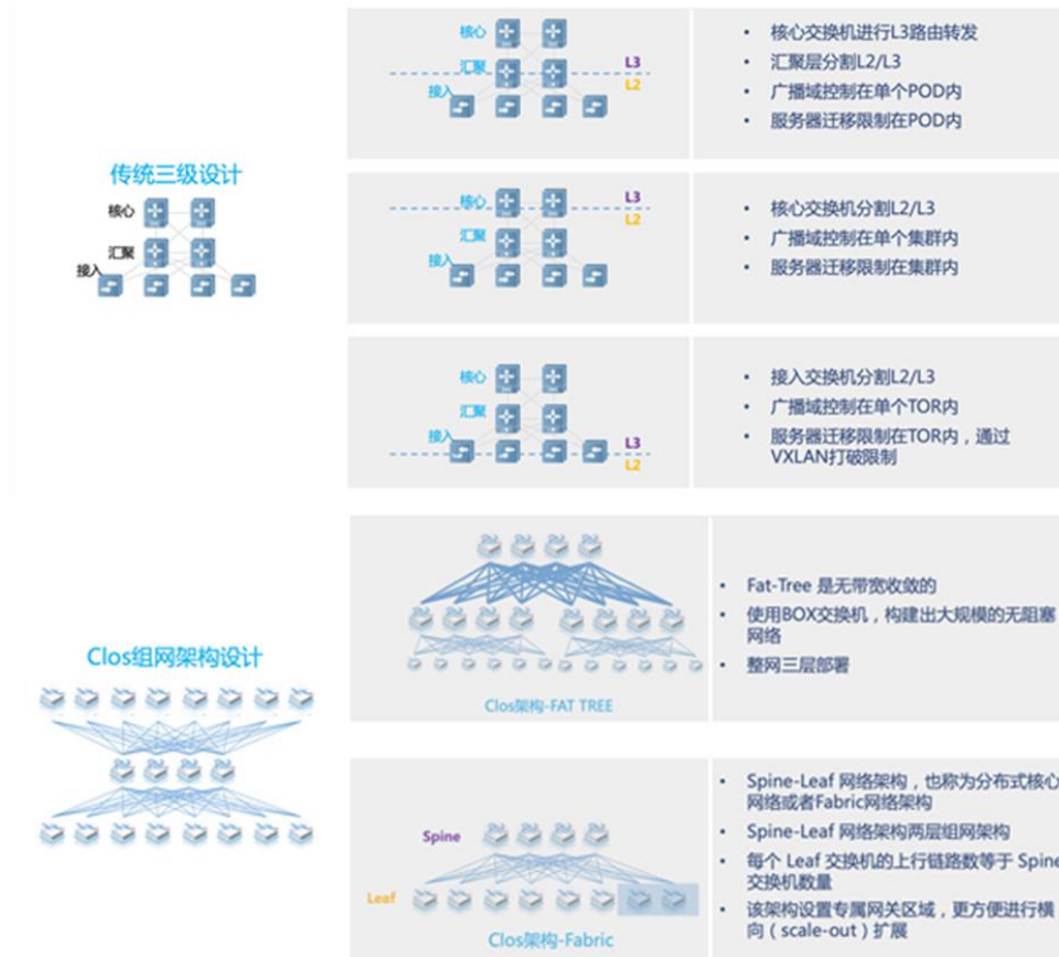
图 20：5G 前传承载需求演进路线，由传统三级设计向 CLOS 架构演进
