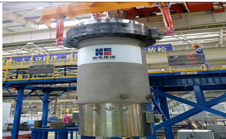
图45: 主泵是核电运转控制水循环的关键
