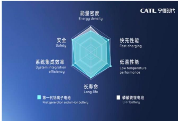
图 17：宁德时代钠电池能量密度接近磷酸铁锂电池下限
