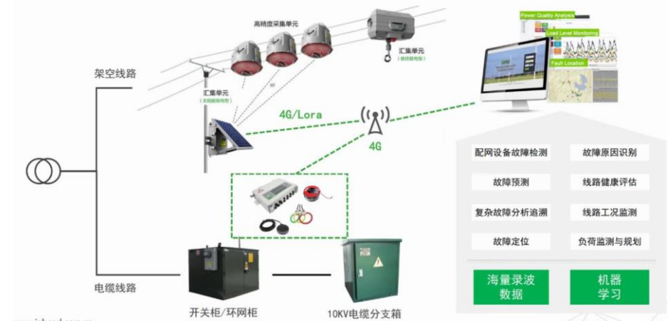
图24：智能配电网线路状态监测系统（IWOS）
