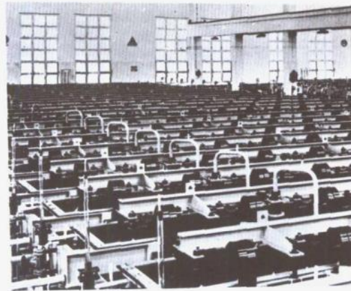
工業用氯皆由左圖所示的電解槽中電解食鹽水而得。當電流經過鹽水時，正極便放出氯氣，負極上便有鈉金屬的沈積。若負極是汞則會產生汞齊，否則鈉在鹽水中會立即與水反應形成苛性鈉。
