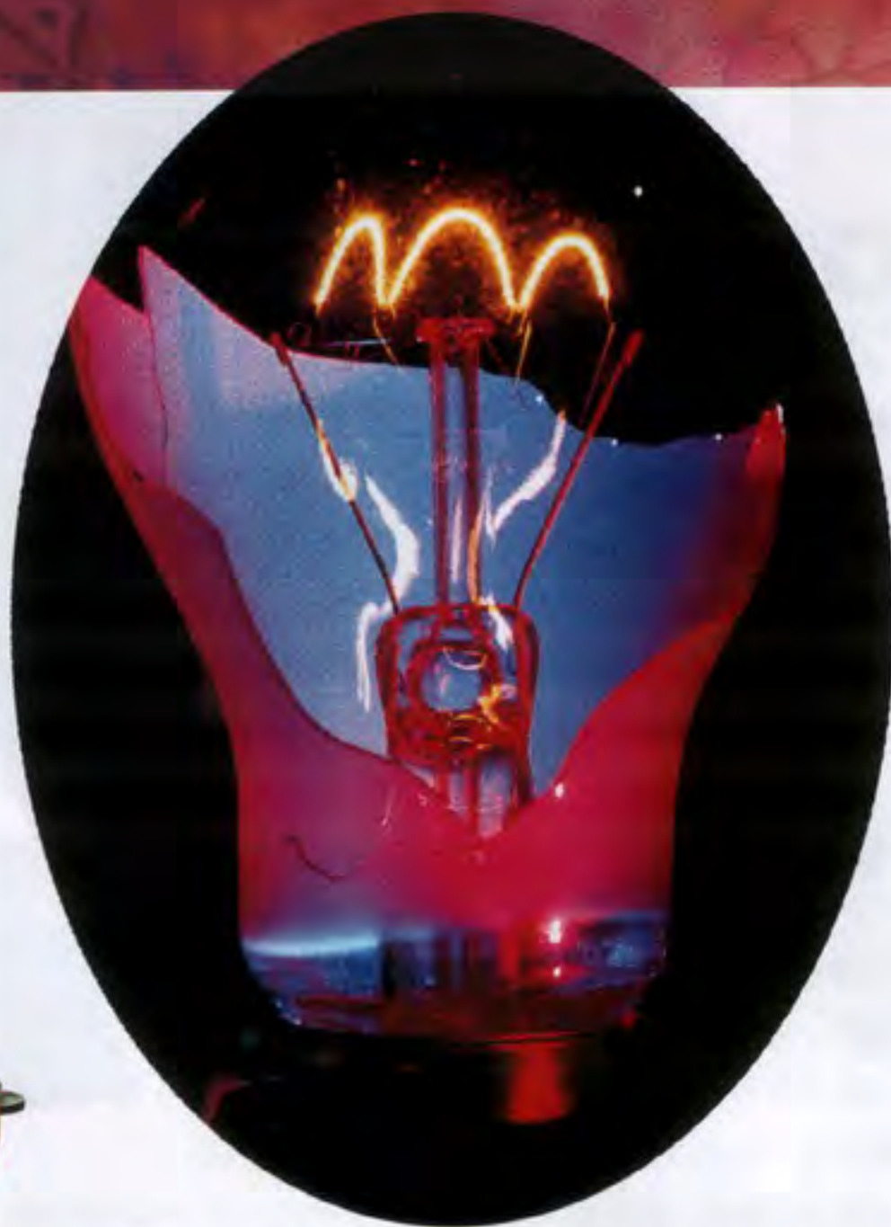
灯泡中的钨丝具有高电阻。通过灯泡的电子使原子快速振动,钨丝和灯泡就热得无法触摸。
