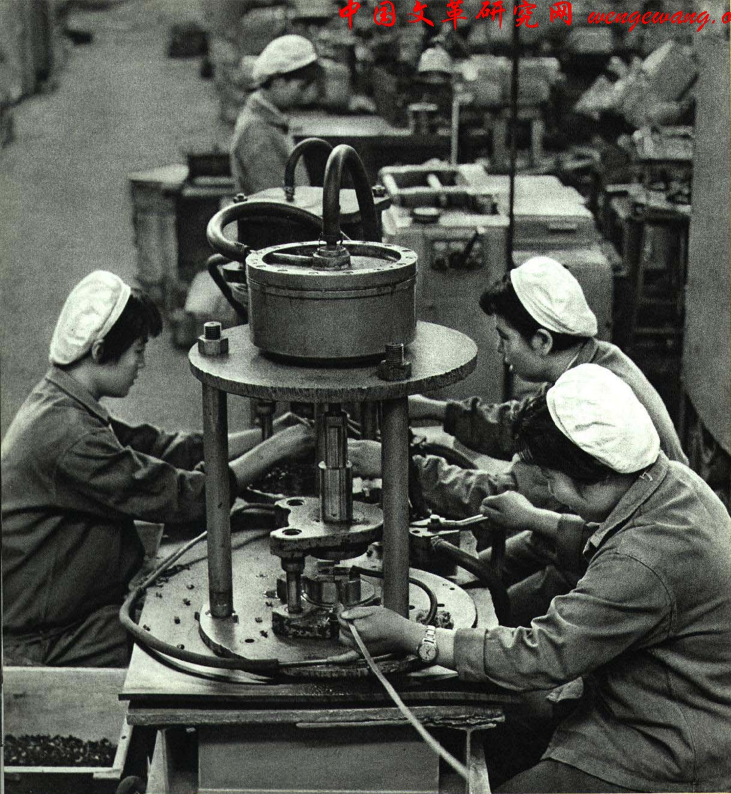
工人们自制的加工汽门锁片的专用设备。
