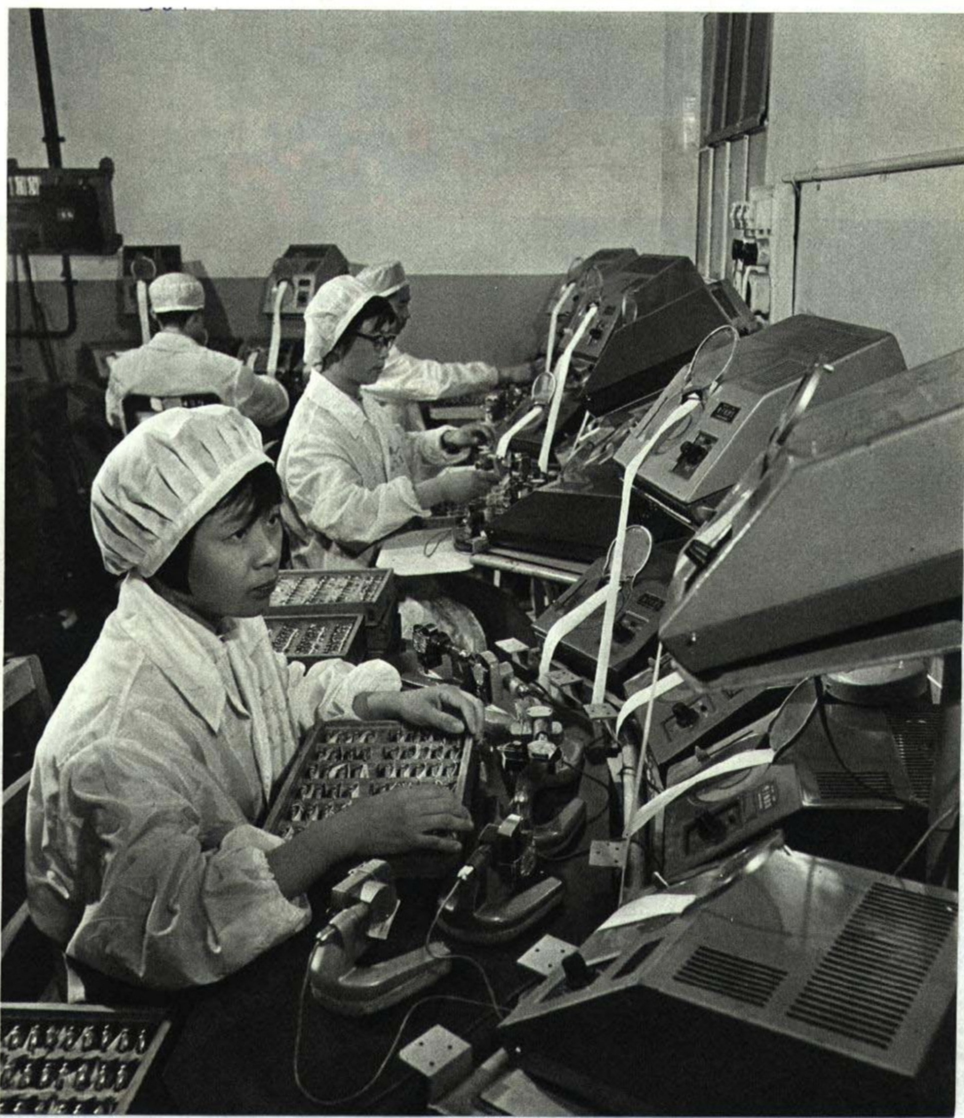
用电子校表仪对每块手表进行严格校验。
