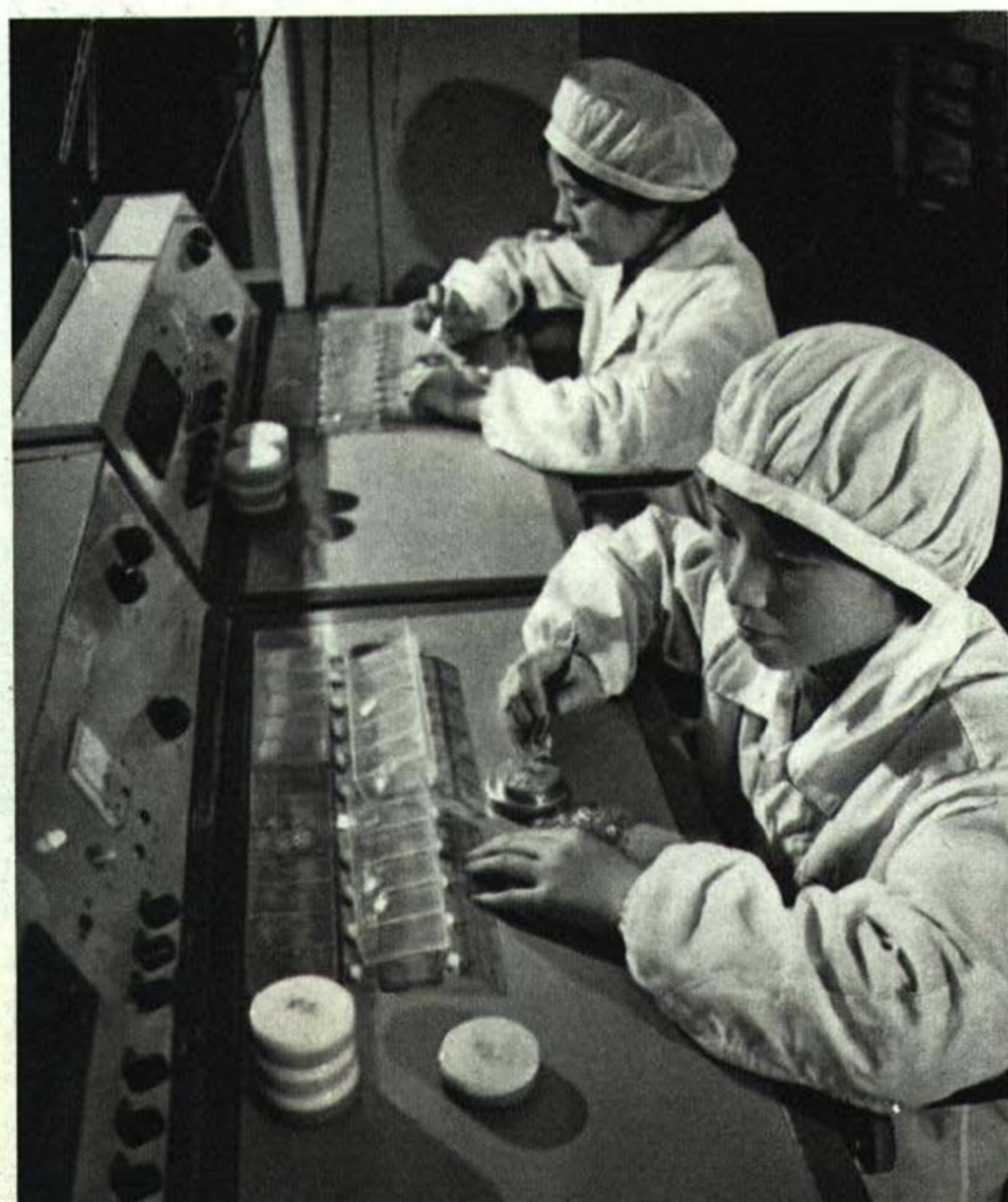
厂里自制的摆轮游丝分档仪，操作方便，专门用来检验组合手表的摆轮和游丝。
