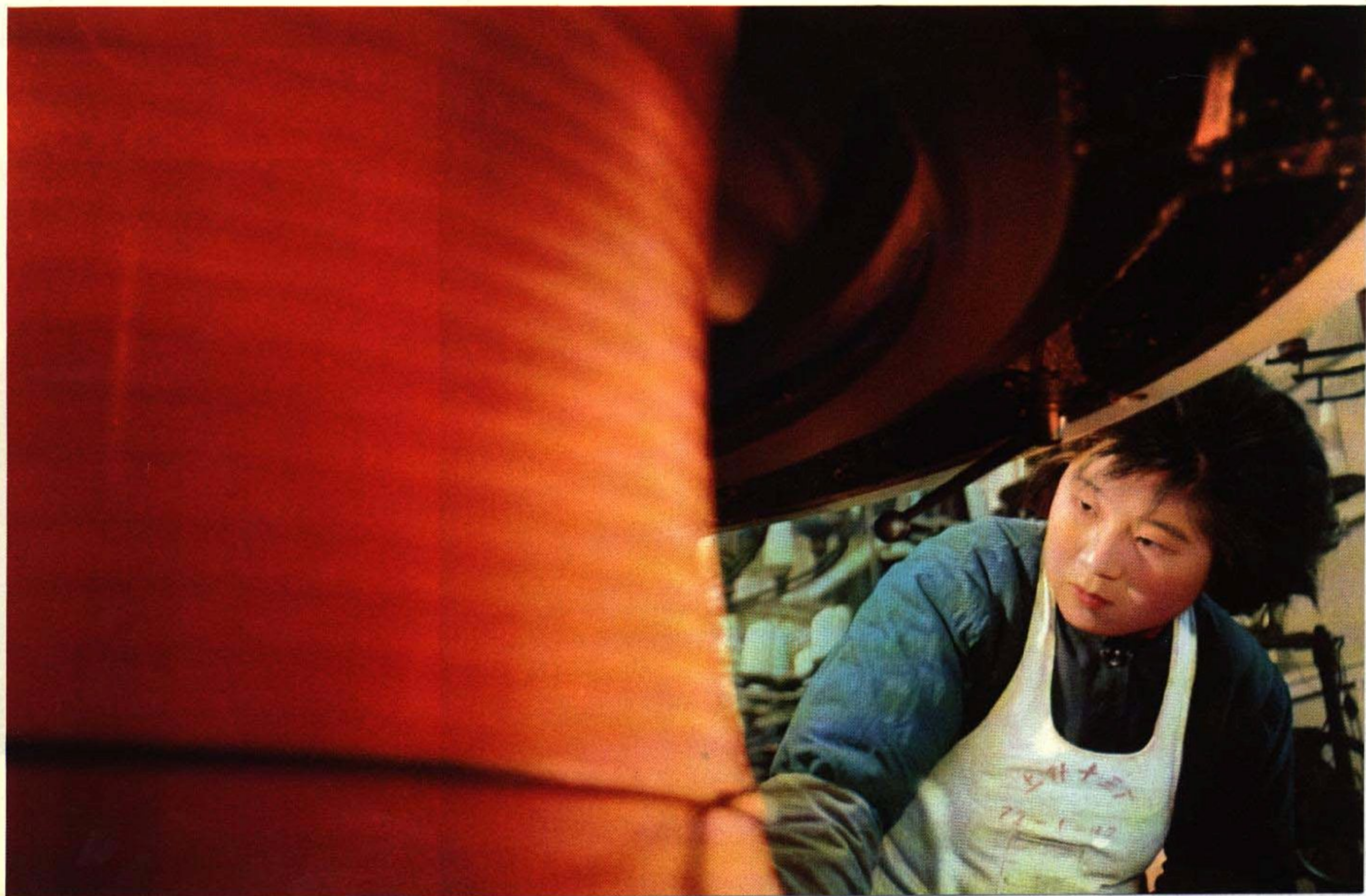
针织十三厂和兄弟厂协作，经过技术 改造，已成批生产针织外衣。这是针 织车间正在生产针织纬编提花布。
