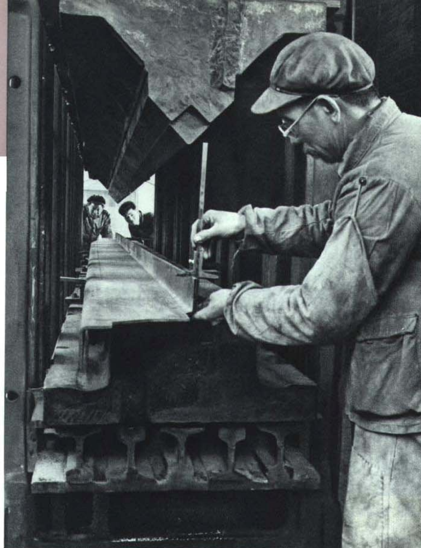
工厂自制的一千零五十吨油压机，解决了压制汽车纵梁的关键问题
