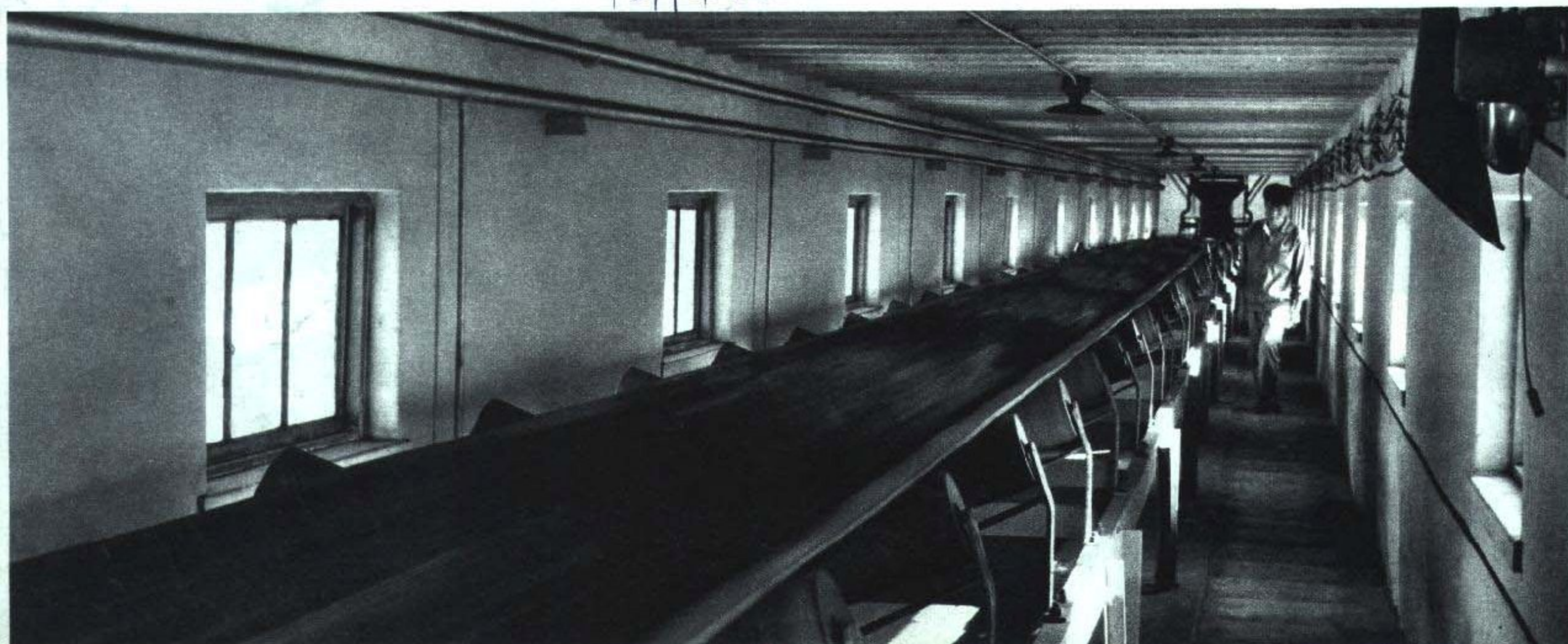
张新竖井的自动化皮带运输机，井下生产的煤通过它送到选煤车间
