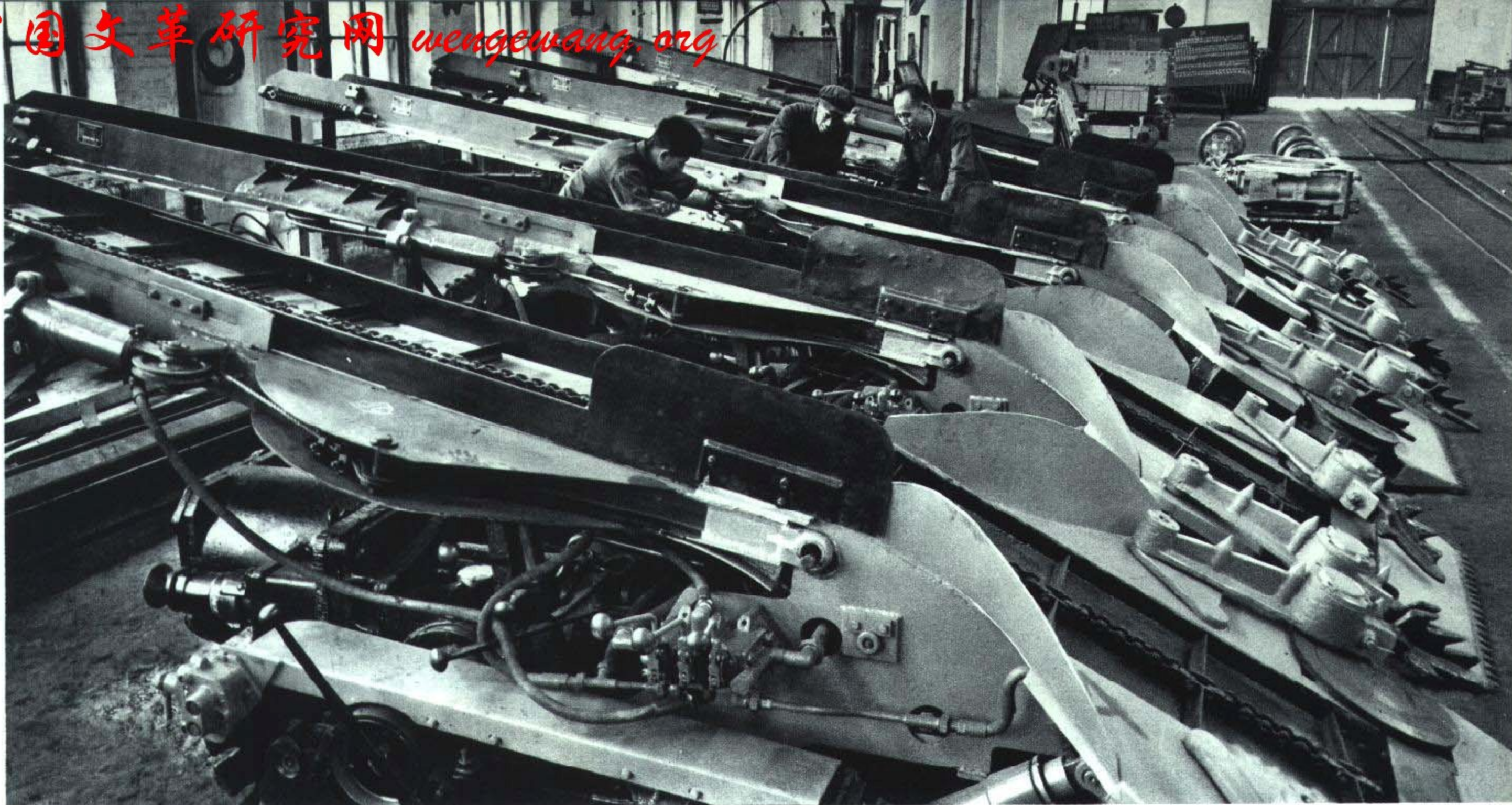
鸡西矿山机械厂在解放前是个小小的修理厂，现在已能大批生产煤矿需要的机械。这是正在装配该厂生产的装岩机
