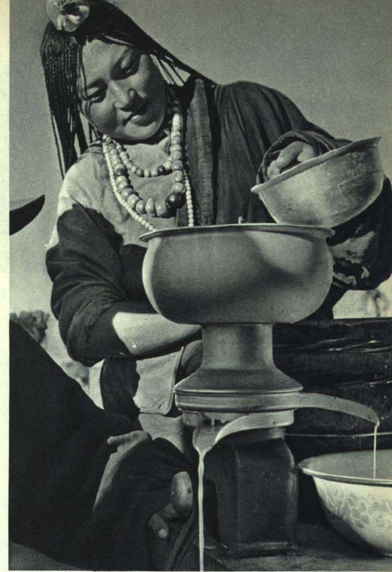
不少牧民采用小型奶油分离器加工牛奶，再也不用牛皮包来打酥油了
