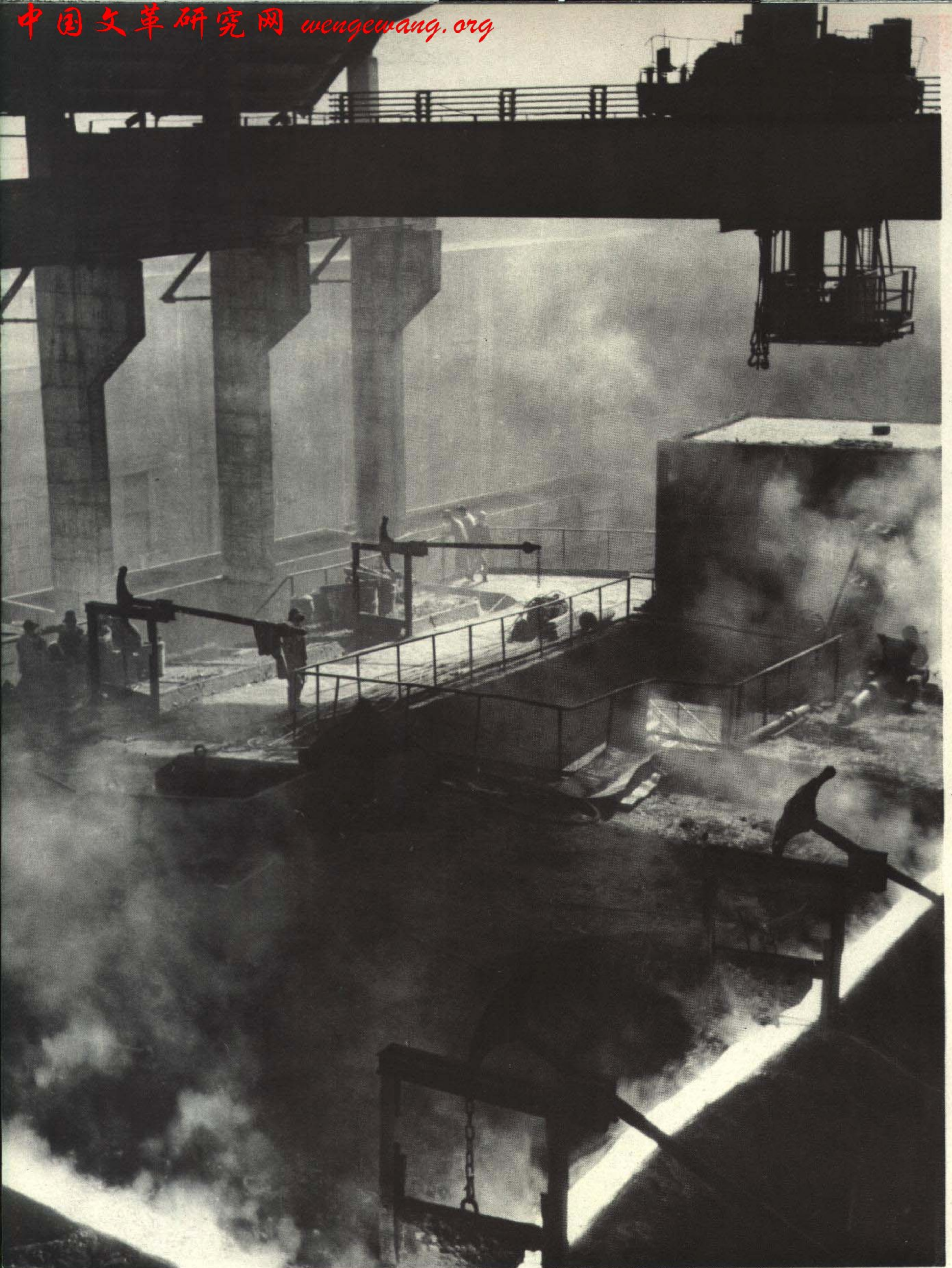
我国新建的大型钢铁联合企业——武汉钢铁公司，几年来，生产能力不断提高，产品品种比 1958 年增加两倍到三倍。这是武钢二号高炉在出铁
