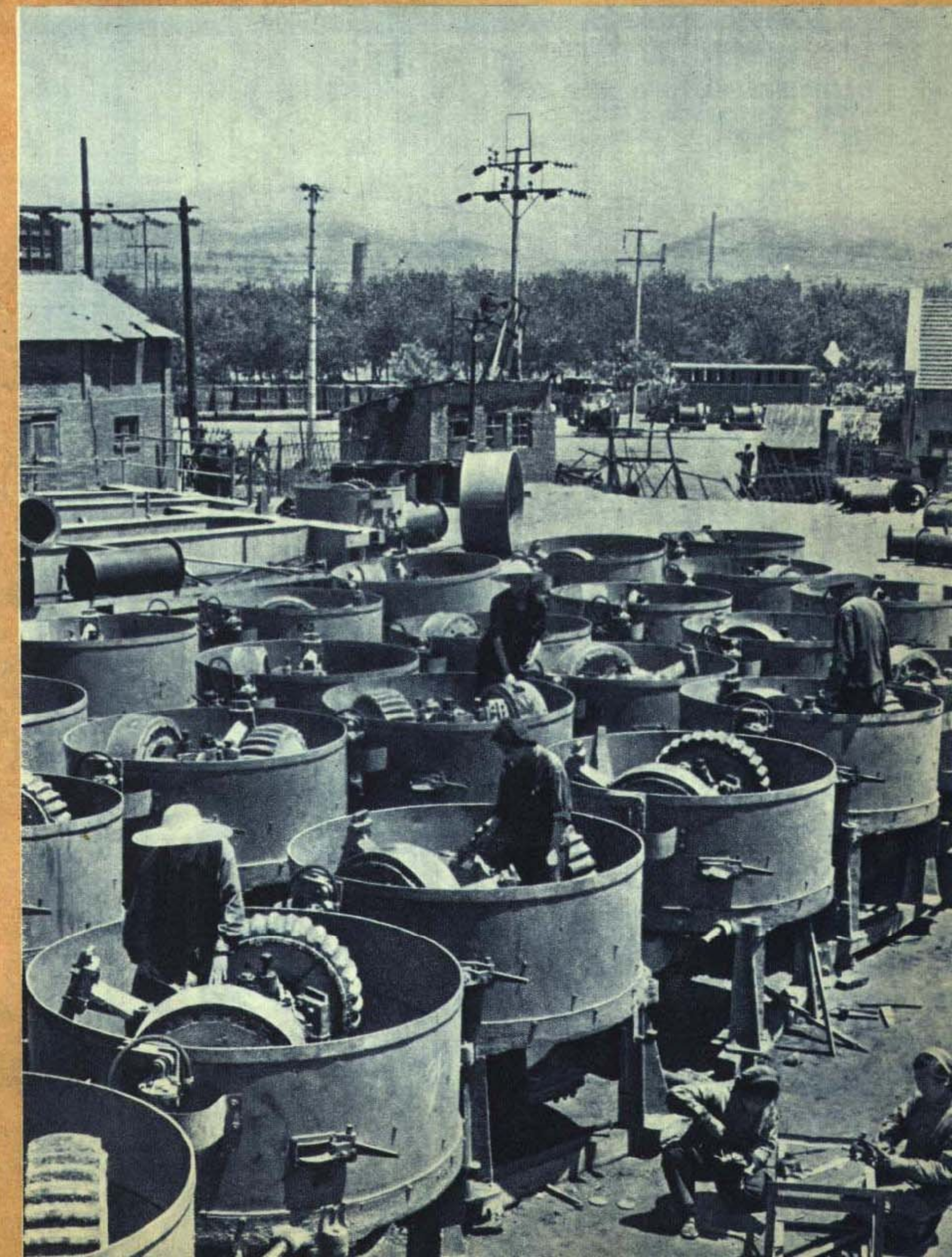
青岛铸造机械厂为节约钢材和提高产品质量，巧改产品设计。这种改革后的滚筒式小型混砂机，容积比原来增加了0.22立方米，达到中型混砂机的生产水平，但钢铁消耗却比生产中型混砂机少用2.2吨 王广均摄影
