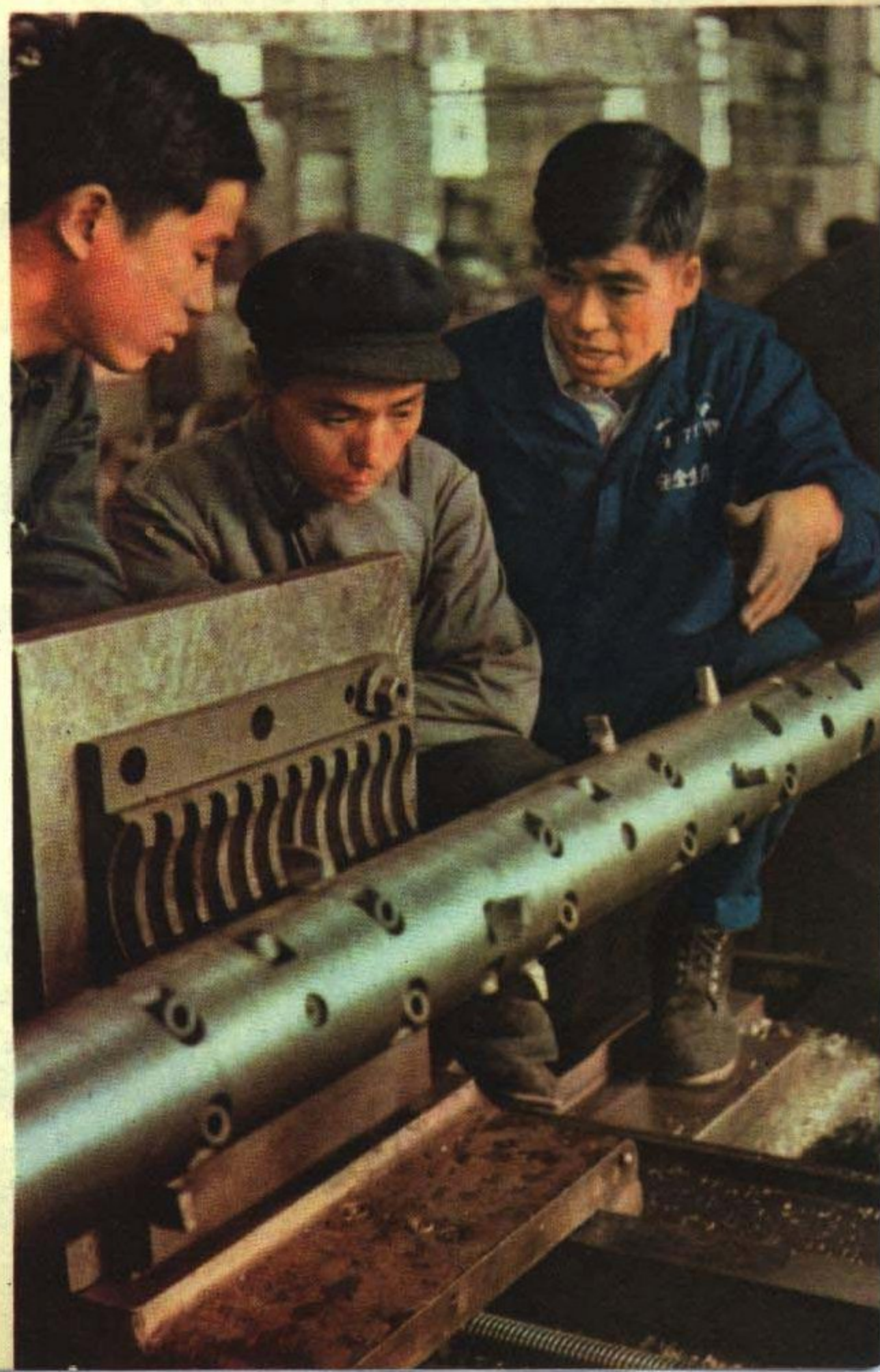
馬学礼刻苦鑽研，創造了多刀梯形刀杆，提高工效六倍，現在他又和技師、技术員研究进一步提高它的效能
