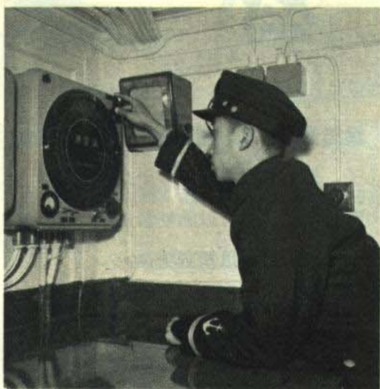
船上的测深仪，可以使船員隨時知道海水的深度。
