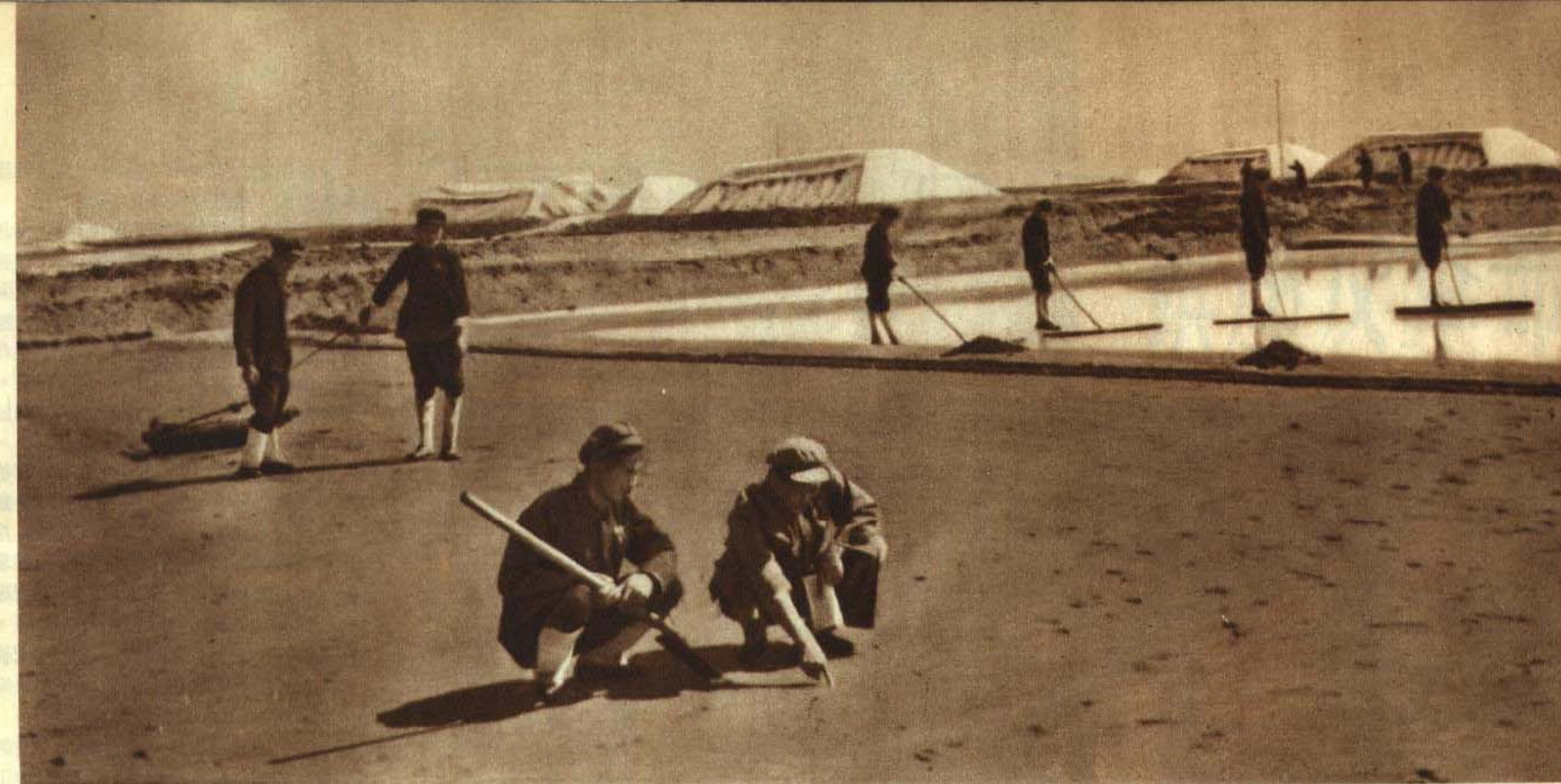
為了使池板能多次使用不壞和使滴水易於結晶，須將剩餘的滴水和浮土混和（叫做起混）存放到滴井去；並分次引進不同濃度的新滴水，將池板重新泡壓（叫做壓板）。唐宗傑科長（右）和董壽蘭技術員（左）在檢查壓板後的池板是否合標準，後面拉滾軸的是工人在壓板，右邊的四人正在利用餘滴來起混。
