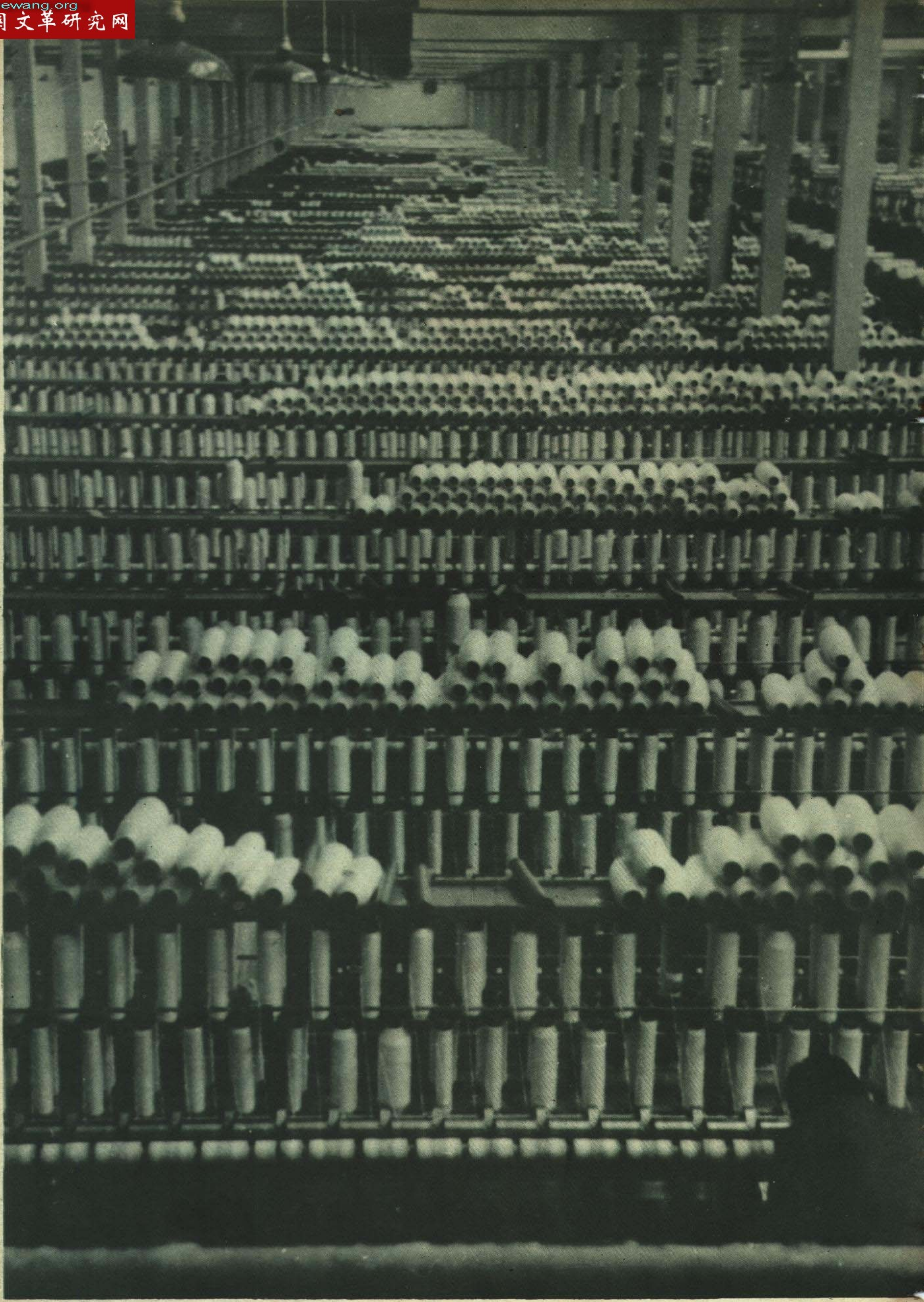
上海國營棉紡二廠細紗車間。裝有通風設備，調節溫、濕度，生產效率因而大大提高
